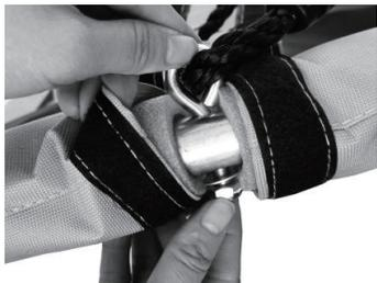
Ziehen Sie ihn mit der Schraubmutter fest, vergessen Sie die Unterlegscheibe nicht.
