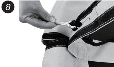
8 Montieren Sie den Schraubbolzen, indem Sie ihn durch den Klettverschlussgürtel fädeln.
