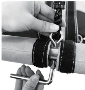
Ziehen Sie die Schraube mit einem Schraubenschlüssel fest, bevor Sie sie verwenden.
