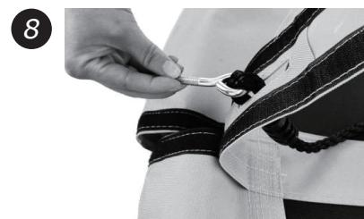
Bevor Sie den Schraubbolzen montieren, stecken Sie ihn zuerst durch den Klettverschlussgürtel.
