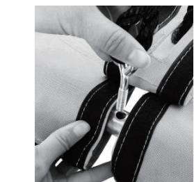
Assemblare il bullone al tubo del telaio.
