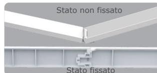
**⚠️ Fissare il supporto dell'asta di collegamento.**
