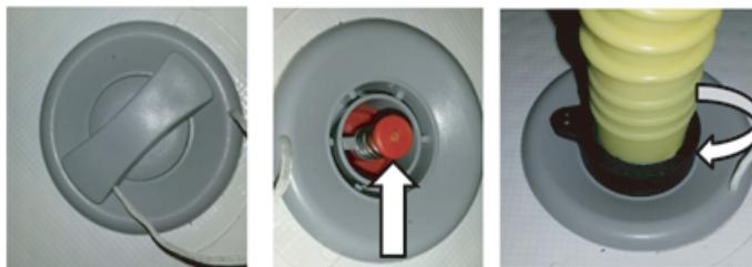
Um das Ventil zum Entleeren zu öffnen, drücken Sie auf die Ventilnadel (sie muss nicht gedreht werden) und stellen sicher, dass sich die mittlere Ventilnadel in der Position "DOWN" befindet.
