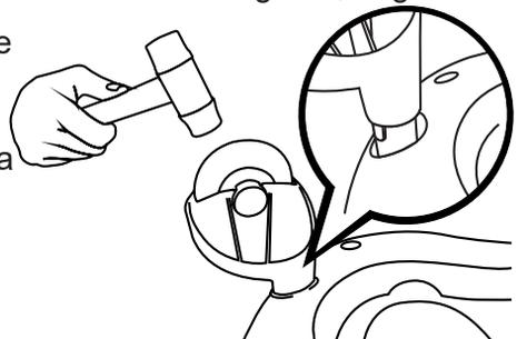
7. Saque el volante, compruebe si el tornillo de expansión está suelto, coloque el cojinete de PP en el soporte de la carrocería.
