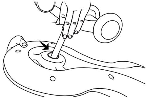
3. Come mostrato in figura, battere nella parte inferiore del meccanismo della ruota davanti con un martello di gomma e inserire completamente il cuscinetto del meccanismo della ruota davanti nel foro della carrozzeria della macchina.
