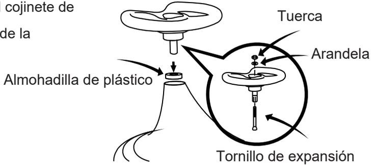
8. Como se muestra en la imagen, ajuste el volante para que el extremo con muesca mire hacia adelante.
