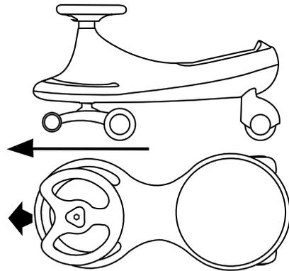
9. Estrarre il tubo di installazione, passare il cacciavite attraverso i due fori del tubo di installazione, utilizzare la forza adeguata per stringere la vite di espansione e fissare il volante, quindi chiudere il foro per completare l'installazione.
