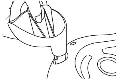
6. Come mostrato in figura, battere nella parte inferiore del meccanismo della ruota posteriore con un martello di gomma, inserire completamente il cuscinetto del meccanismo della ruota posteriore nel foro della carrozzeria della macchina.
