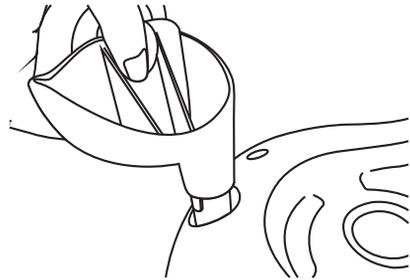
6. Jak pokazano na rysunku, od spodu mechanizmu tylnego koła należy uderzyć młotkiem z gumową główką, aby całkowicie włożyć łożysko mechanizmu tylnego koła w otwór w korpusie.
