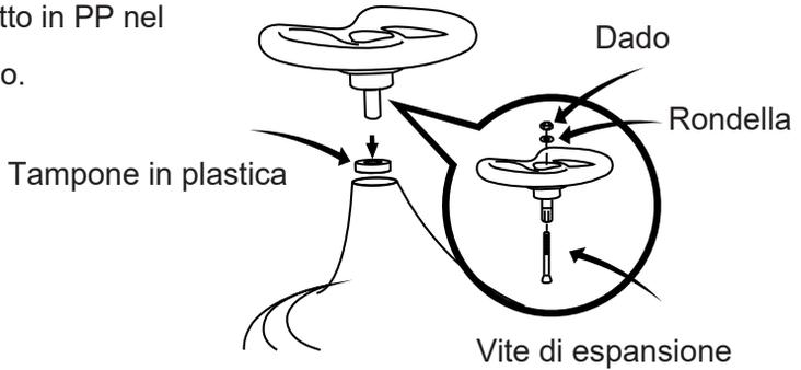
8. Come mostrato in figura, regolare il volante in modo che l'estremità dentellata del volante sia rivolta in avanti.
