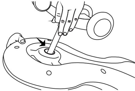
3. Wie in der Abbildung gezeigt, mit einem Gummihammer auf die Unterseite des Vorderradmechanismus klopfen und das Lager des Vorderradmechanismus vollständig in das Loch des Körpers einsetzen.
