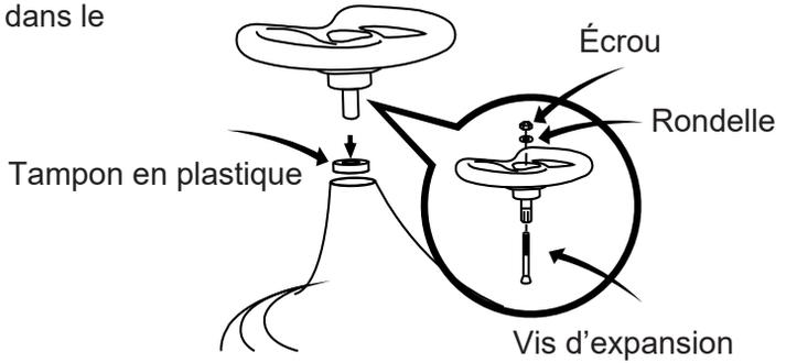
8. Comme le montre la photo, ajustez le volant et placez l'extrémité crantée du volant vers l'avant.
