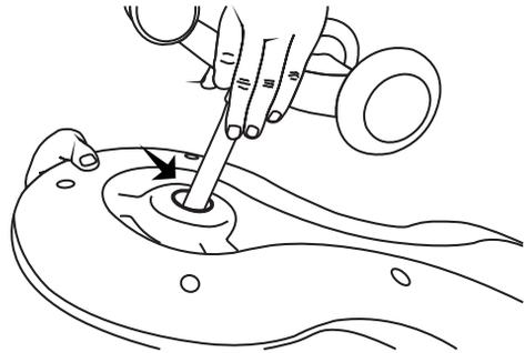
3. Como se muestra en la imagen, golpee la parte inferior del mecanismo de la rueda delantera con un martillo de goma e inserte completamente el cojinete del mecanismo de la rueda delantera en el orificio de la carrocería.
