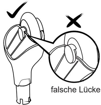
5. Passen Sie wie in der Abbildung gezeigt das „L“ oder „R“ der Hinterräder an den Buchstaben der Karosserie an und setzen Sie gleichzeitig das Hinterrad in das Loch ein.
