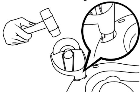
7. Estrarre il volante, controllare se la vite di espansione è allentata, inserire il cuscinetto in PP nel supporto del corpo.
