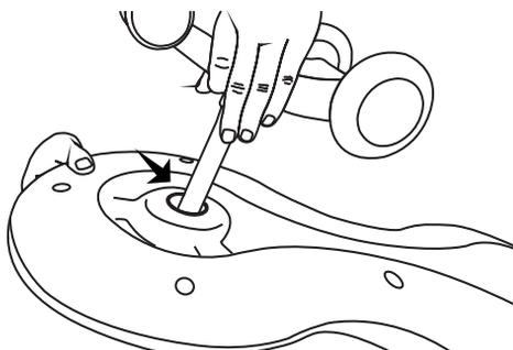
3. Jak pokazano na rysunku, od spodu mechanizmu przedniego koła należy uderzyć młotkiem z gumową główką, aby całkowicie włożyć łożysko mechanizmu przedniego koła w otwór w korpusie.
