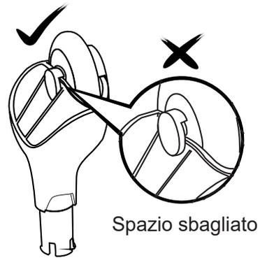
5. Come mostrato in figura, combaciare la "L" o la "R" delle ruote posteriori con la lettera della carrozzeria della macchina e contemporaneamente inserire la ruota posteriore nel foro.
