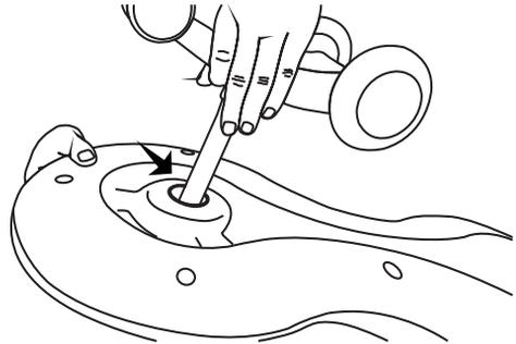
3. Comme le montre la photo, on frappe au bas du mécanisme de la roue avant à l'aide d'un marteau en caoutchouc pour insérer complètement le palier du mécanisme de la roue avant dans le trou de la carrosserie.
