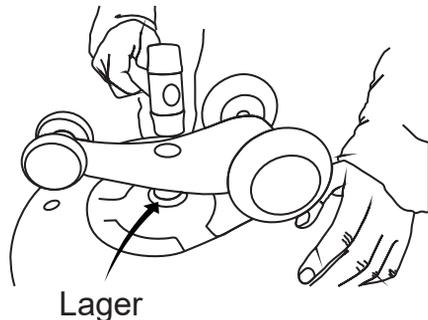
4. Überprüfen Sie, wie in der Abbildung gezeigt, ob der Knopf des Rads an der richtigen Stelle installiert ist, und stellen Sie sicher, dass dieser Knopf den Boden erreicht.
