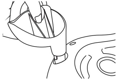
6. Como se muestra en la imagen, golpee la parte inferior del mecanismo de la rueda trasera con un martillo de goma, haga que el cojinete del mecanismo de la rueda trasera se inserte completamente en el orificio de la carrocería.
