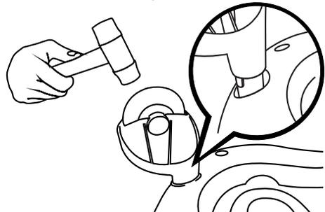
7. Sortez le volant, vérifiez si la vis d'expansion est desserrée, mettez le palier PP dans le support du corps.
