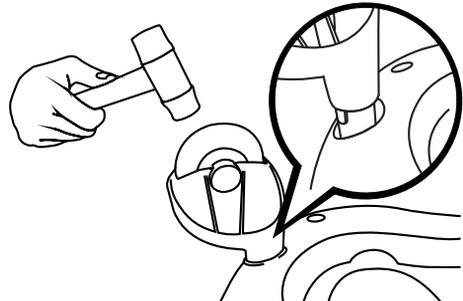
7. Wyjmij koło zamachowe, sprawdź, czy śruba rozporowa jest luźna, włóż łożysko PP do wspornika korpusu.
