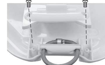
Coloque la cubierta de cuerda elástica sobre el lazo de cuerda elástica y el pasador de pivot. Asegure la cubierta en su lugar utilizando dos tornillos M4x12mm.
