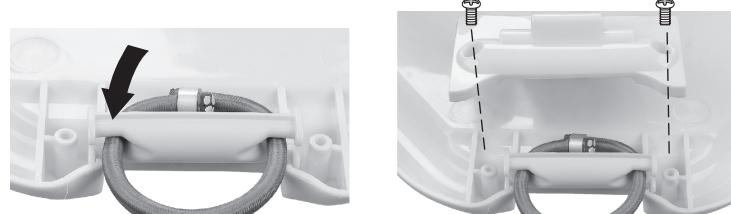
Posizionare la copertura elastica sull'anello elastico e sul perno di articolazione. Fissare il coperchio in posizione utilizzando due viti M4x12 mm.
