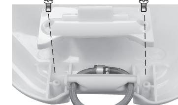
Placez le protège-élastique sur la boucle élastique et sur la broche ante. Fixez le protège-élastique en place à l'aide de deux vis M4 x 12mm.
