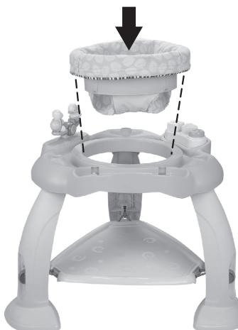
Posizionare il sedile nella superficie di gioco. Assicurarsi che le quattro linguette evidenziate si inseriscano nel bordo interno della superficie. Il supporto del sedile deve ruotare liberamente all'interno della superficie di gioco. Il supporto del sedile deve essere completamente posizionato per evitare di essere facilmente estratto.
