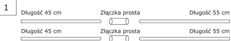
Użyj złączki prostej, aby połączyć rurę 45 CM z rurą 55 CM, jak pokazano na rysunku, tworząc konstrukcję złożoną z 2 rur.
