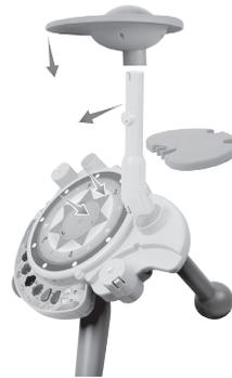
Inserte en la posición del agujero según la dirección correcta.
